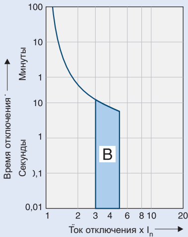
Характеристика отключения B (расцепитель короткого замыкания 3 – 5 I n )
