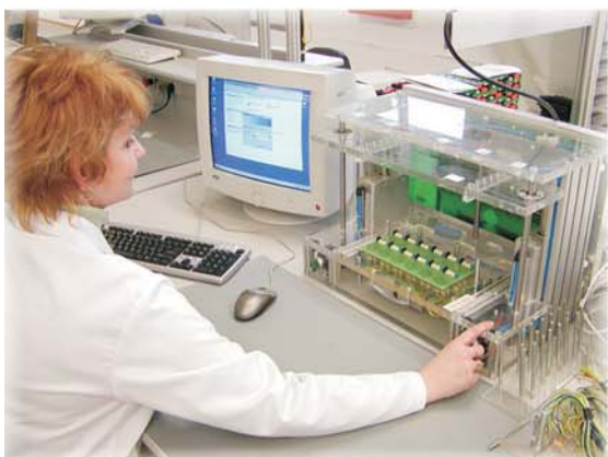
9) После обязательного тестирования в фазе полуфабриката на игольчатых тестерах, производится составление и последующая комплектация изделия в коробочки.
