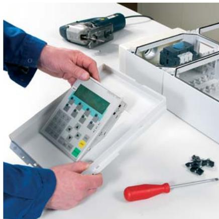
Установите пластрон в раму двери с обратной стороны. Закрепите раму с дверью и пластроном к основанию корпуса.
