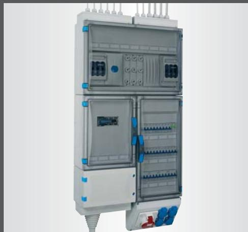
Комбинируемая система корпусов с полной изоляцией, степенью защиты IP66, для сборки распределительного устройства ENYSTAR на токи до 250А, рассчитанная на обслуживание неквалифицированным персоналом, согласно ГОСТ Р МЭК 61439-3.
