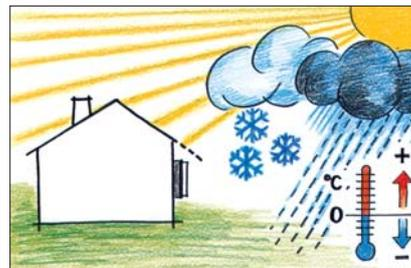
В этом случае образование конденсата зависит от погоды, высокой влажности воздуха, прямого солнечного света и разницы между температурой корпуса НКУ и стены, на которой оно установлено.
